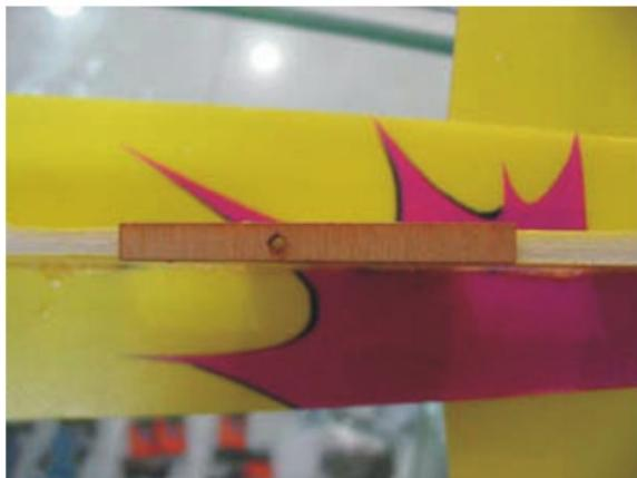
2、将后起落架钢丝插入固定片的小孔，并用纤维胶带加固
