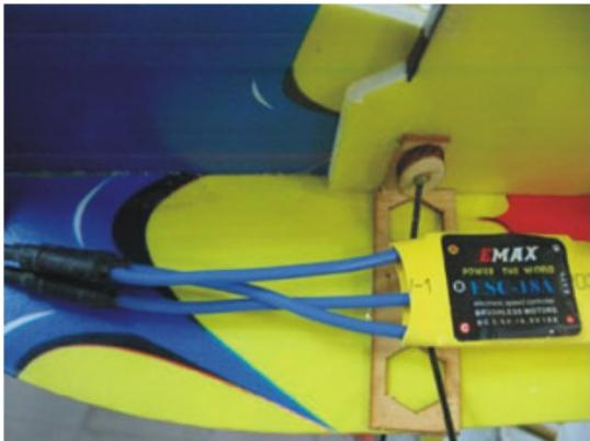
2、将电调信号线插入接收机第3通道，拉到最远处后，再把接收机用双面胶固定在电池座对立面的机身下方。
